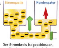
3. Stromquelle, Kondensator. Der Kondensator ist geladen.
